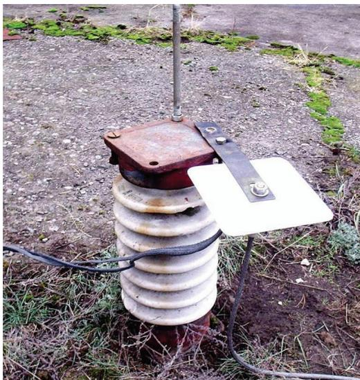
Рисунок 4 – Внешний вид нижнего стержневого стального электрода  $\varnothing$  20 мм и подсоединенных к нему измерительного шунта ШК-300 и заземленной гибкой стальной шины при испытаниях электрической прочности длинных воздушных промежутков
