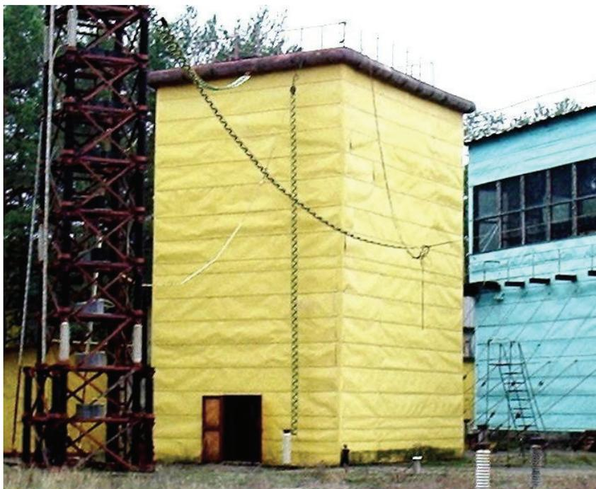
Рисунок 1 – Внешний вид мегавольтного генератора ГИИТ-4/1, размещенного на испытательном полигоне института, и двухэлектродной системы «стержень–стержень» при испытаниях электрической прочности длинных воздушных промежутков
